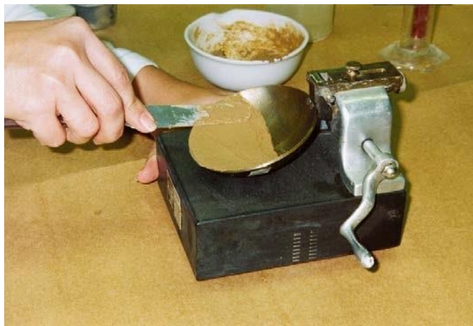
Figura 125 - 6. Colocación del suelo dentro de la cazuela
